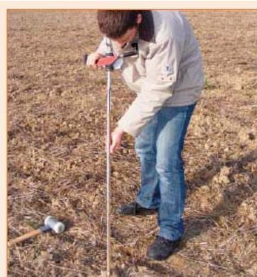
2. Le principe de l'AGRO Sonde®VM permet un échantillonnage direct sur les 3 horizons. La dissociation de l'enfoncement et du prélèvement évite ainsi tout risque de mélange d'horizon.
