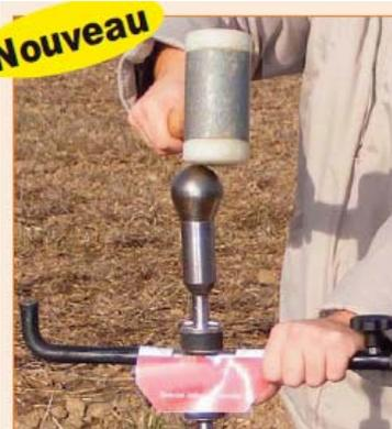
3. Un maillet spécial a été conçu pour rendre la frappe plus confortable en conditions sèches ou compactes (moins de raie et plus d'inertie lors de la frappe grâce à une grenaille mobile à l'intérieur du marteau).
