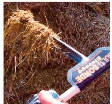
3. Les dents spécialement profilées permettent un échantillonnage de toutes les fibres, même les plus conséquentes.
