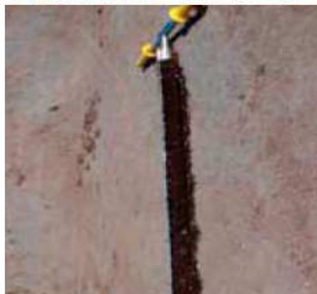
2. Son principe permet de prélever en une seule fois un échantillon représentatif sur une profondeur de 1 mètre.
