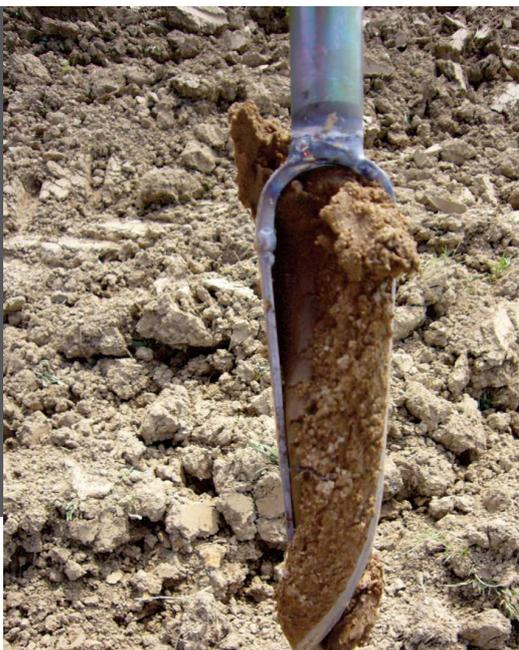
Tarière agricole hélicoïdale, polyvalente, robuste et légère (1,3 Kg) de 125 cm. Sa longueur et la robustesse de sa lame permettent de descendre à 90 cm en 6 horizons de 15 cm. Son diamètre de 50 mm est le mieux approprié au prélèvement de reliquats azotés. Convient pour tous les types de sols et quelque soit l'humidité.
