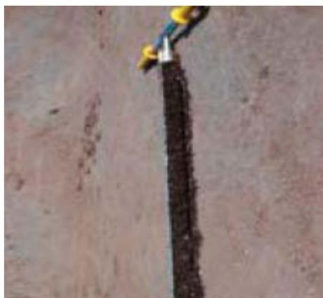
2. Son principe permet de prélever en une seule fois un échantillon représentatif sur une profondeur de 1 mètre.
