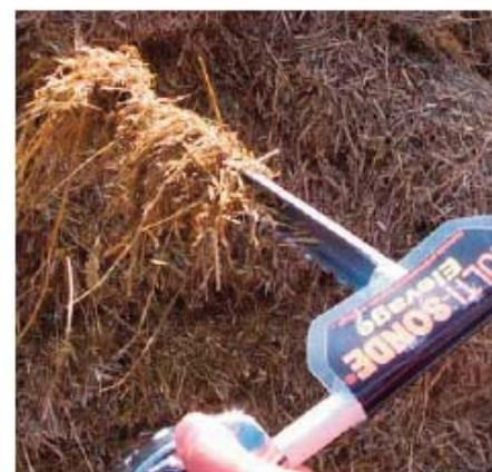
3. Les dents spécialement profilées permettent un échantillonnage de toutes les fibres, même les plus conséquentes.
